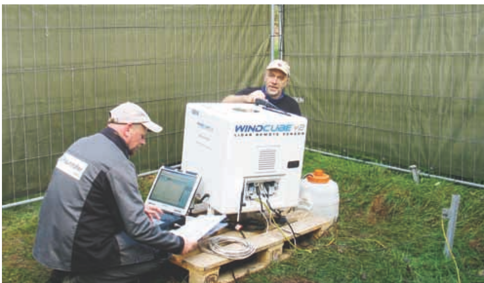
Aufbau eines LiDAR-Gerätes zur Bestimmung des Windpotenzials an einem Waldstandort FOTO: FRAUNHOFER IEE
