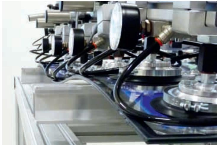
TPedge-Modul mit 2 mm Dünnglas während der Flächenlastprüfung
